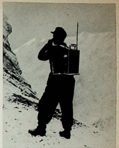
UKW-Sprechfunk als Helfer in Bergnot. Mit dem Telefunken-Teleport verständigen sich die Suchtruppe der Bergwacht bei Lawineneingriffen und Bergungsarbeiten, wenn in dem unwegsamem Gelände keine Sichtverbindung besteht
