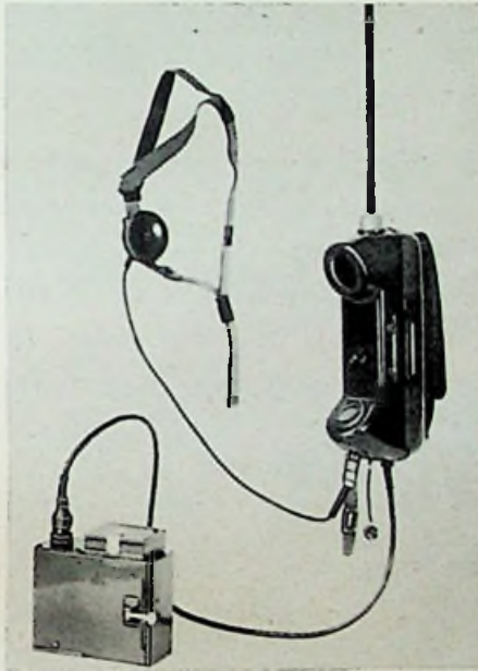
Bild 1. Handfunksprecher KL 9 von Lorenz
